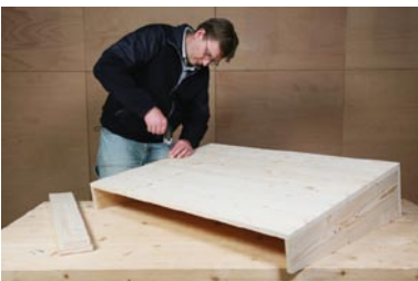
Die Seitenteile mit der Grundplatte verschrauben
