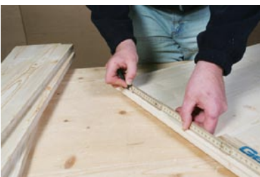
9,5 Millimeter von der Außenkante abmessen
