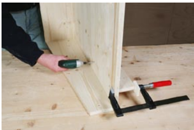
Von oben die unteren Seitenteile verschrauben
