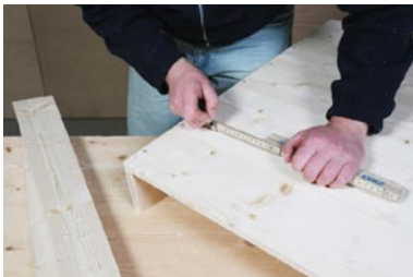
Den Abstand von der Kante abmessen, mit dem die Auflage auf der Kommode aufliegen soll
